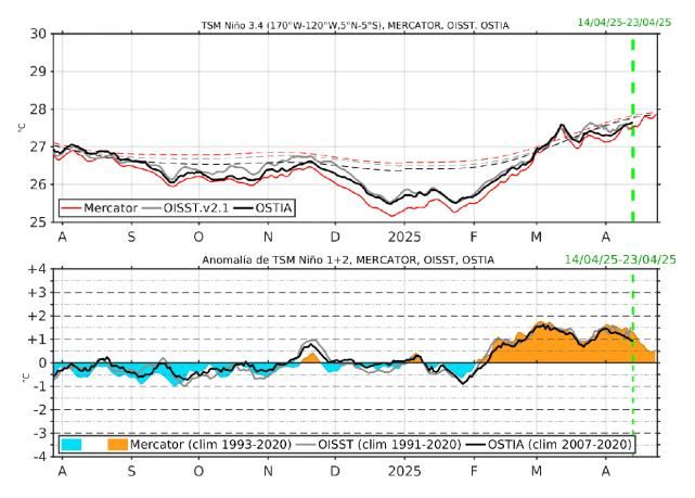
Figura 32. Pronóstico a corto plazo de la temperatura superficial del mar (TSM) según el modelo MERCATOR (rojo); y series de tiempo observadas de TSM según OISST (gris), OSTIA (negro), (arriba); y pronóstico de la anomalía de TSM según modelo MERCATOR (sombreado rojo y azul), y series de tiempo observadas de la anomalía de TSM según OISST (gris), OSTIA (negro), (abajo), en la región Niño 1+2. Procesamiento: LMOECC/AFIOF/DGIOCC/IMARPE.
