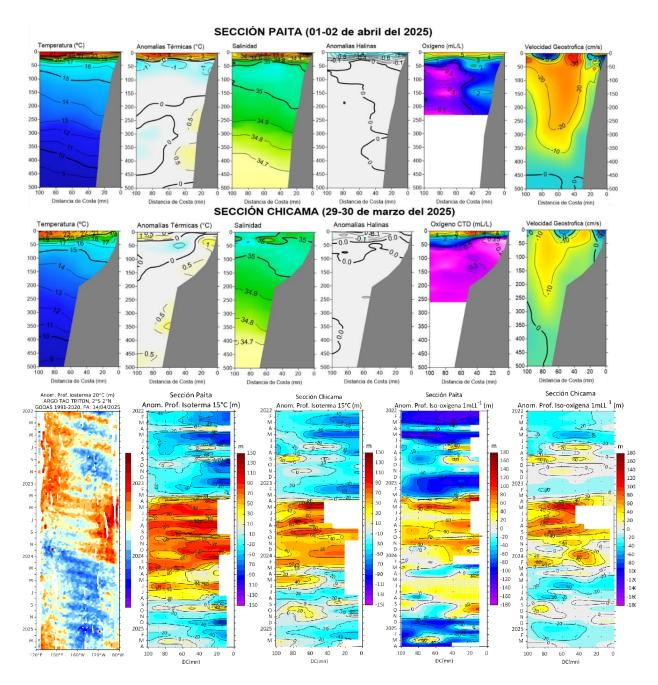
Figura 27. (a – b) Secciones oceanográficas de temperatura, anomalía térmica, salinidad, anomalía halina, y oxígeno disuelto, realizadas frente a Paita y Chicama dentro de las 100 mn, entre el 29 de marzo y 02 de abril del 2025; c) diagramas Hovmöller de la anomalía de la profundidad de la termoclina (isoterma de 15 °C) y de la profundidad de la oxiclina (iso-oxígena de 1mL L<sup>-1</sup>) frente a Paita y a Chicama. Climatología: (Domínguez et al., 2023).
